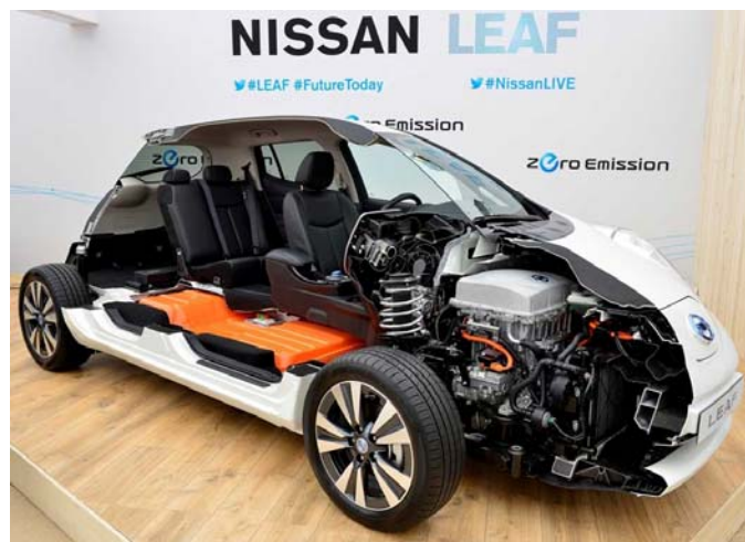
Figura 20 - Corte lateral de um Nissan Leaf [29]
